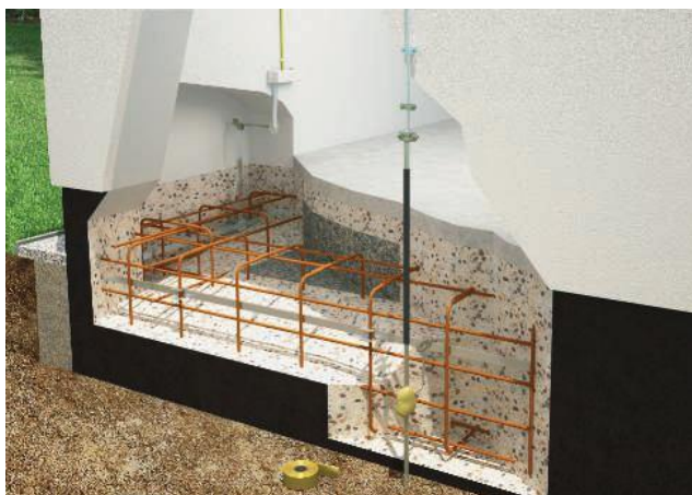
شکل (۲-۱۱): الکتروود مدفون در بتن
